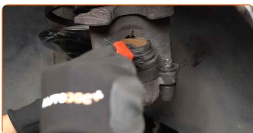
**Výměna: brzdového kotouče - VW Caddy I Pick-up (14). Tip:**
