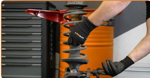
Výměna: uložení tlumiče - VW Caddy II Combi (9K9B). Tip:
