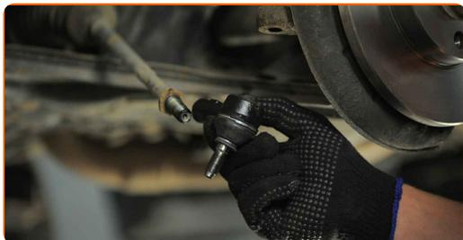
**Výměna: kulového čepu řízení - VW Caddy II Combi (9K9B). Tip od odborníků z AUTODOC:**
