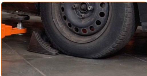
**2** Uvolněte upevňovací šrouby kola. Použijte rázový nástavec na kolo č. 17.
