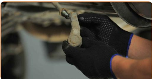
**13** Vyčistěte montážní pozice čepu táhla řízení. Použijte drátěný kartáč. Použijte sprej WD-40.
