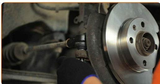
**16** Utáhněte upevňovací matici spojující čep táhla řízení k hlavě ložiska čepu kola. Použijte nástavec č.19. Použijte momentový klíč. Utáhněte ji točivým momentem 35 Nm.
