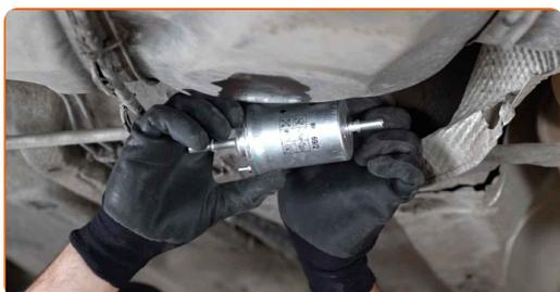
Výměna: palivového filtru - VW Caddy III Van (2KA, 2KH, 2CA, 2CH).
