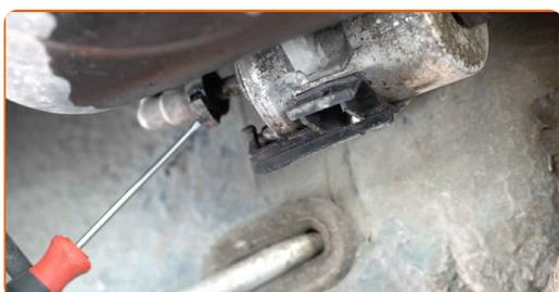
Výměna: palivového filtru - VW Caddy III Van (2KA, 2KH, 2CA, 2CH). Tip:
