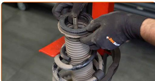
Výměna: uložení tlumiče - VW California T5 Mikrobus (7EC, 7EF, 7EG, 7HF).
