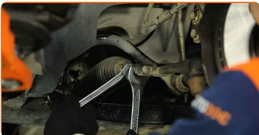
**9** Vyčistěte upevnění spojující čep táhla řízení k hlavě ložiska čepu kola. Použijte drátěný kartáč. Použijte sprej WD-40.
