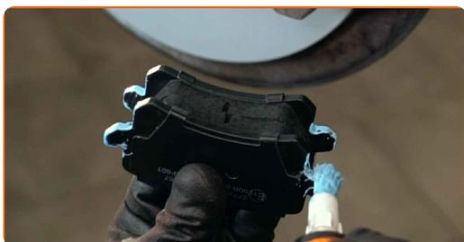
Výměna: brzdové destičky - VW CC (358). Tip:
