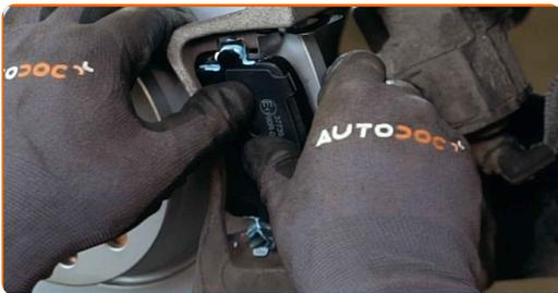
Výměna: brzdové destičky - VW CC (358). Tip od odborníků z AUTODOC:
