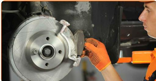
Výměna: brzdové destičky - VW CORRADO (53I). AUTODOC doporučuje:
