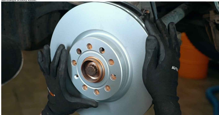
24 Upevněte upevnění brzdového kotouče. Použijte hvězdicový Torx T 30. Použijte momentový klíč. Utáhněte ji točivým momentem 4 Nm.
