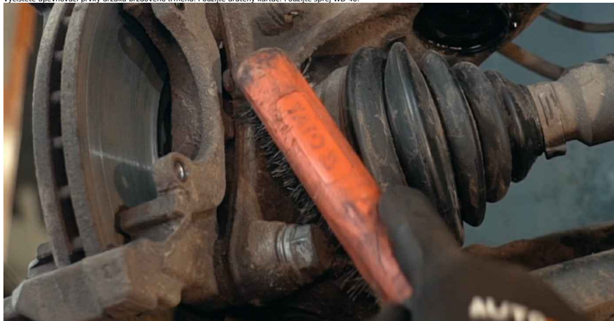
Odsroubujte upevnění svorky brzdového třmenu. Použijte nástavec č.21. Použijte ráčnový klíč. Použijte vratidlo.
