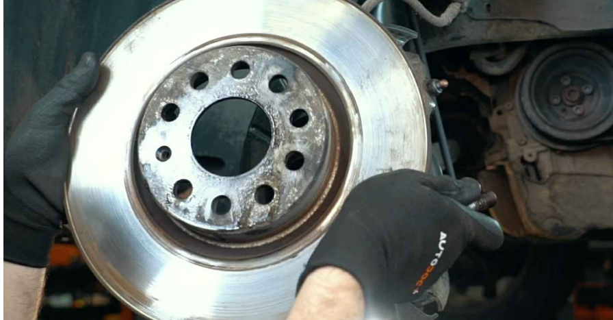
22 Vyčistěte náboj. Použijte drátěný kartáč. Nařete kontaktní povrch. Použijte měděné mazivo.
