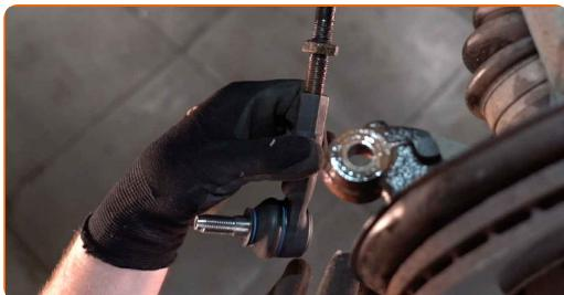
**Výměna: kulového čepu řízení - VW Fox Hatchback (5Z1, 5Z3, 5Z4).**
