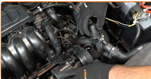
**4** Překryjte kanálky sekundárního vzduchového čerpadla látkou z mikrovlákna, aby se dovnitř nedostal prach a špína.
