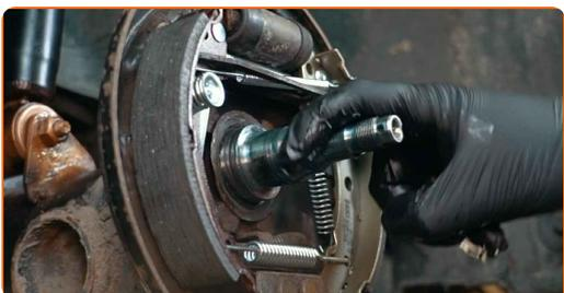
**15** Nainstalujte nový brzdový buben sestavený s ložiskem náboje kola.
