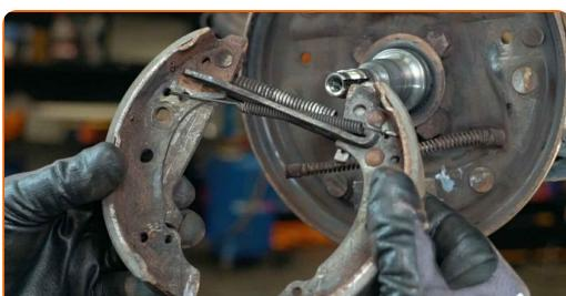
**Výměna: brzdové čelisti - VW GOLF III Variant (1H5). Tip od odborníků z AUTODOC:**
