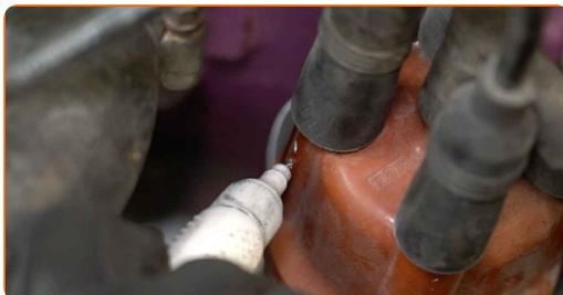
**4** Odpojte vodiče zapalovací svíčky od víka rozdělovače.
