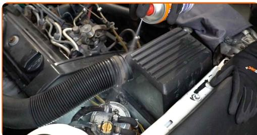
**4** Uvolněte upevnění palivového filtru. Použijte nástavec č.13. Použijte ráčnový klíč.
