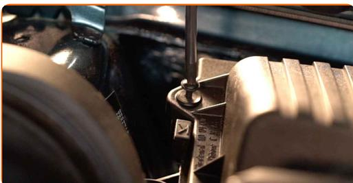
**4** Odpojte svorku přívodní vzduchové hadičky. Použijte kleště na vodní pumpu.
