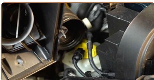
12 Nainstalujte nový filtrační prvek do krytu filtru. Ujistěte se, že okraj filtru je těsně připevněn ke krytu.
