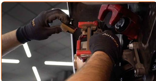
Výměna: brzdové destičky - VW Golf IV Variant (1J5). Tip od AUTODOC:
