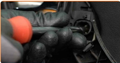
**4** Odpojte panel dveří. Použijte plastový nástroj na demontáž čalounění.
