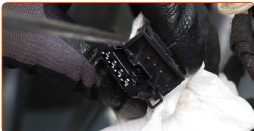
**47** Ošetřete konektor modulu spínače elektrických oken. Použijte dielektrické mazivo.
