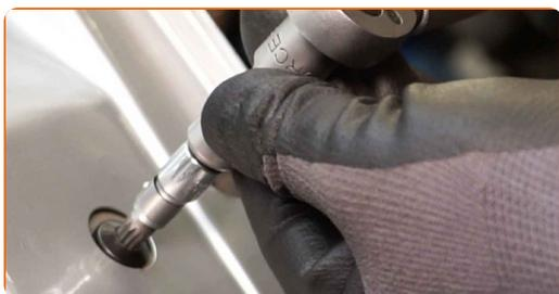
**53** Utáhněte upevňovací prvky panelu dveří. Použijte nástavec č.10. Použijte momentový klíč. Utáhněte ji točivým momentem 8 Nm.
