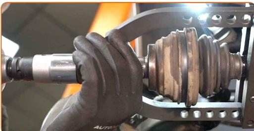
**21** Odpojte homokinetický kloub. Použijte stahovák homokinetického kloubu.
