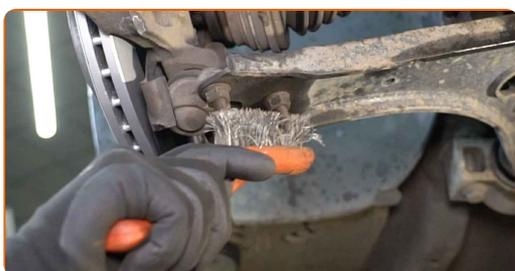
**12** Odšroubujte upevňovací prvek spojující kulový čep a ovládací rameno odpružení. Použijte nástavec č.16. Použijte ráčnový klíč.
