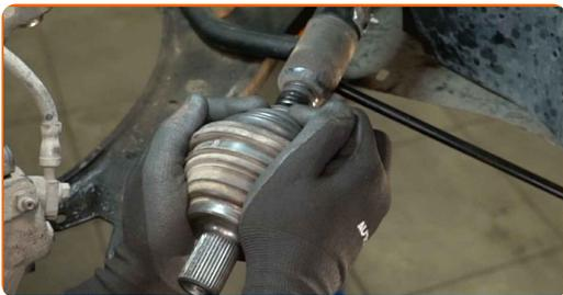
**19** Připevněte stahovák homokinetických kloubů.
