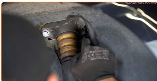
22 Utáhněte upevnění uložení tlumiče. Důležité! Nezapomeňte použít nové upevňovací prvky. Použijte nástavec č.16. Použijte momentový klíč. Utáhněte ji točivým momentem 50 Nm.+45°
