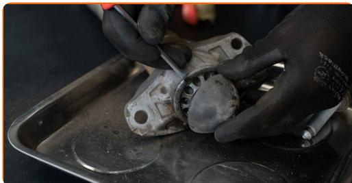
13 Odstraňte upevnění tyče pístu tlumiče. Použijte kombinační klíč č.16. Použijte nastavitelný klíč.
