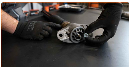
**17** Zašroubujte vrchní uložení pístu vzpěry tlumiče. Použijte kombinační klíč č.16. Použijte nastavitelný klíč. Použijte momentový klíč. Utáhněte ji točivým momentem 25 Nm.
