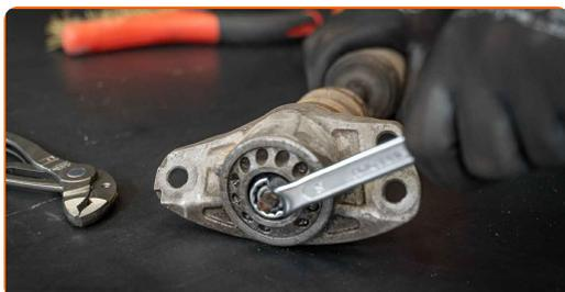
14 Odstraňte uložení tlumiče, návlek a tlumící doraz.
