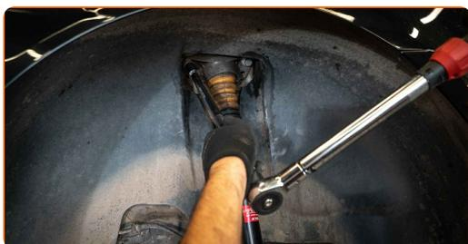
23 Utáhněte spodní upevnění tlumiče. Použijte nástavec č.21. Použijte momentový klíč. Utáhněte ji točivým momentem 180 Nm.
