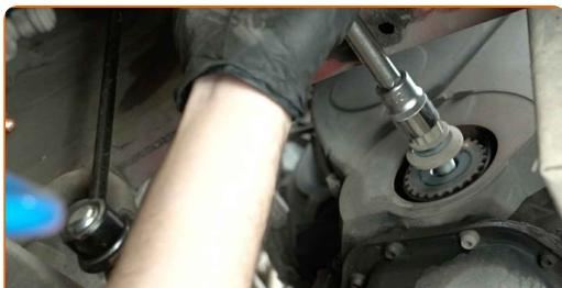
**24** Odšroubujte upevňovací prvky spodního krytu rozvodů motoru. Použijte nástavec č.10. Použijte ráčnový klíč.
