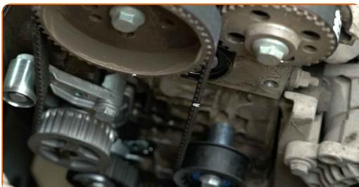
Výměna: vodní čerpadlo + sada rozvodového řemene - VW Golf V Variant (1K5). Tip:
