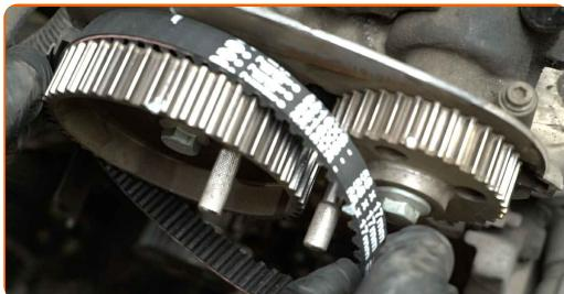
Výměna: vodní čerpadlo + sada rozvodového řemene - VW Golf V Variant (1K5). Doporučují odborníci z AUTODOC:
