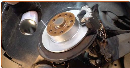
Výměna: brzdového třmenu - VW GOLF VI (5K1). Tip od AUTODOC:
