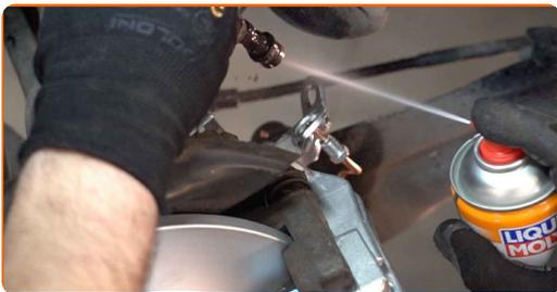
Výměna: brzdového třmenu - VW GOLF VI (5K1). Profesionálové doporučují:
