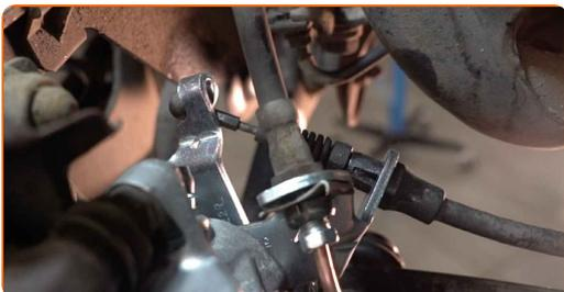
**29** Odpojte odvzdušňovací šroub brzdového třmenu. Použijte páčidlo.
