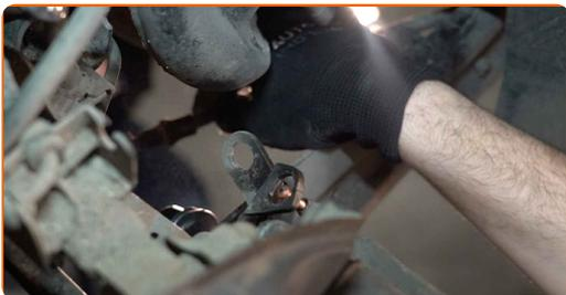
**15** Odšroubujte upevňovací prvek spojující brzdovou trubku k brzdové hadičce. Použijte kombinační klíč č.13.
