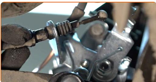
**28** Zajistěte lanko parkovací brzdy pomocí zádržného kroužku.
