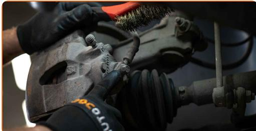
Výměna: brzdového třmenu - VW Golf VI Van (5K1\_). Tip:
