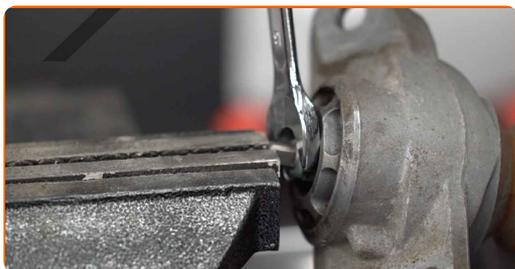
16 Odstraňte uložení tlumiče, návlek a tlumící doraz.
