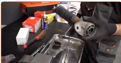
17 Nainstalujte nové ložisko vzpěry, manžetu a doraz na tlumič.
