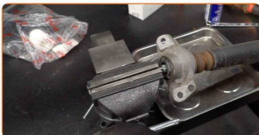
15 Odstraňte upevnění tyče pístu tlumiče. Použijte kombinační klíč č.14.
