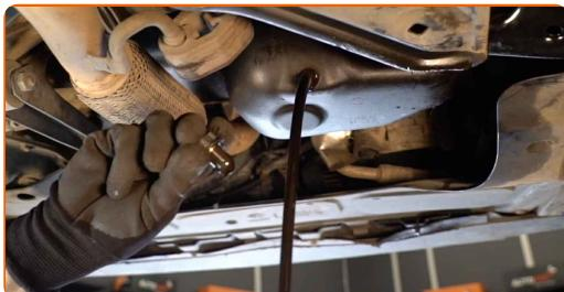
Výměna: motorového oleje a filtru - VW Golf VII Variant (BA5, BV5). Tip od
