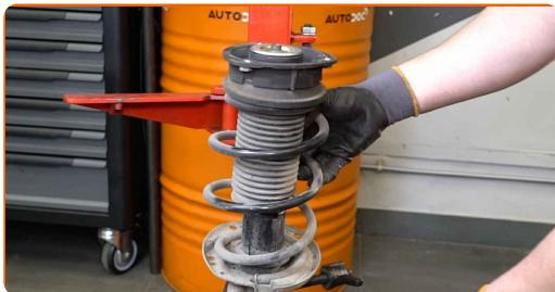
Výměna: uložení tlumiče - VW Golf VII Variant (BA5, BV5). Profesionálové doporučují:
