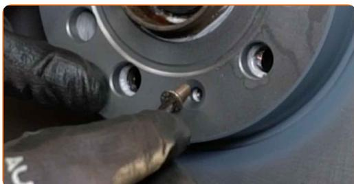
**25** Upevněte upevnění brzdového kotouče. Použijte hvězdicový Torx T 30. Použijte momentový klíč. Utáhněte ji točivým momentem 8 Nm.
