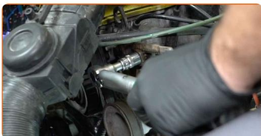
**33** Utáhněte upevňovací prvky kladky vodní pumpy. Použijte imbusový klíč č. H6. Použijte momentový klíč. Utáhněte ji točivým momentem 9 Nm.
