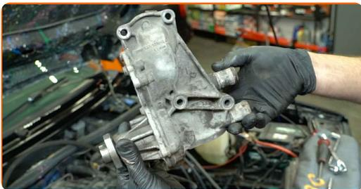
Výměna: vodní pumpy - VW Jetta II (19E, 1G2, 165). AUTODOC doporučuje:
