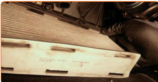
**Výměna: kabinového filtru - VW Jetta Mk5 (1K). Tip od odborníků z AUTODOC:**
