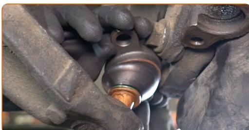
Výměna: kulový čep ramene - VW Multivan VI (SGF, SGM, SGN). Tip od AUTODOC:
