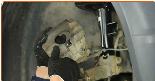
Výměna: brzdového třmenu - VW Multivan VI (SGF, SGM, SGN). Profesionálové doporučují:
