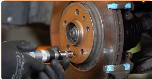
Výměna: brzdového kotouče - VW New Beetle Cabrio (1Y7). Doporučují odborníci z AUTODOC:
