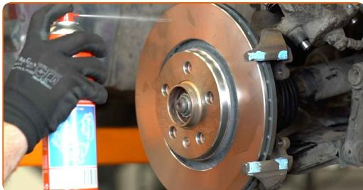
Výměna: brzdového kotouče - VW New Beetle Cabrio (1Y7). Tip od odborníků z AUTODOC:
