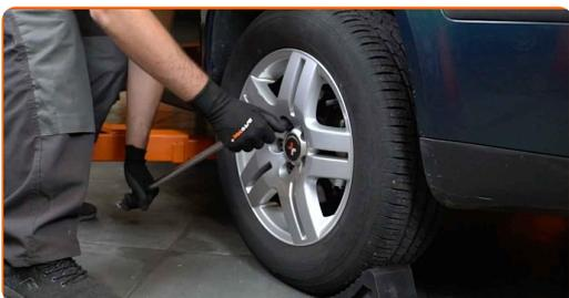
**6** Zvedněte přední část vozidla a zajistěte vozidlo na podpěrách.
