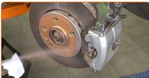
**34** Vyčistěte povrch brzdového kotouče. Použijte čistič brzd.
