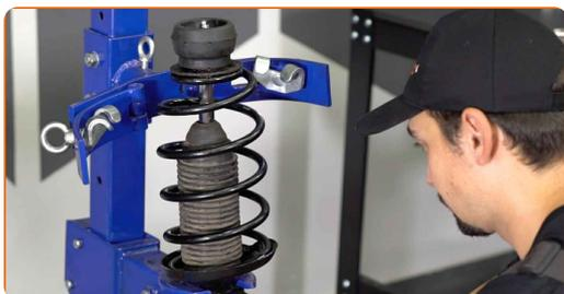
**32** Nainstalujte vzpěru tlumiče do oblouku kola.
