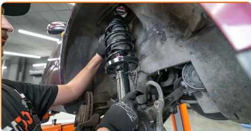
**33** Upevněte vrchní uložení vzpěry tlumiče.
