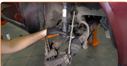
Výměna: uložení tlumiče - VW New Beetle Cabrio (1Y7). AUTODOC doporučuje:
