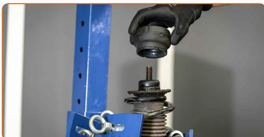
**27** Vyčistěte montážní místo ložiska vzpěry tlumiče. Použijte drátěný kartáč.
