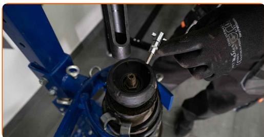
**26** Odstraňte ložisko vzpěry tlumiče.
