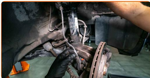
**11** Odšroubujte upevňovací prvek spojující hnací hřídel a náboj kola. Použijte 1-3/16" 12-hranový nástrčný klíč.
