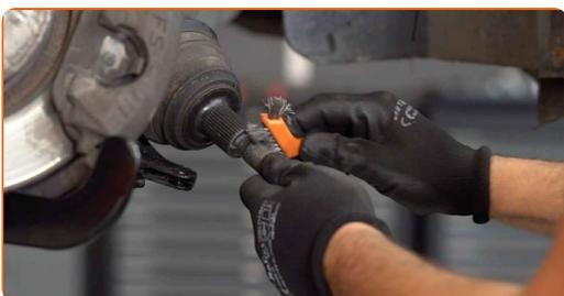
**35** Upevněte vzpěry tlumiče k táhlu řízení.
