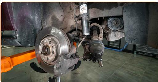
Výměna: uložení tlumiče - VW New Beetle Cabrio (1Y7). Tip:
