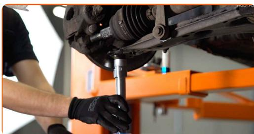
**17** Odšroubujte spodní upevňovací prvek spojující vzpěru tlumiče a hlavu ložiska čepu kola. Použijte kombinační klíč č.18. Použijte nástavec č.18. Použijte ráčnový klíč.
