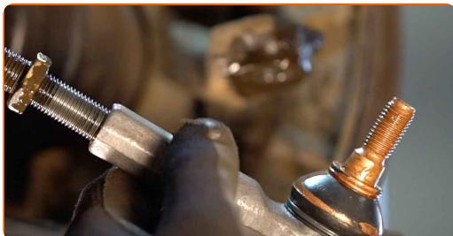
**Výměna: kulového čepu řízení - VW New Beetle Hatchback (9C1, 1C1). Tip od odborníků z AUTODOC:**
