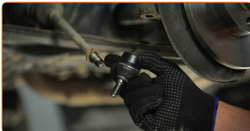
**Výměna: kulového čepu řízení - VW PASSAT (315, 3A5). Tip od odborníků z AUTODOC:**
