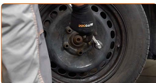
Výměna: kulového čepu řízení - VW PASSAT (315, 3A5). AUTODOC
