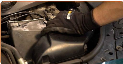
**15** Nainstalujte kryt vzduchového filtru a upevněte ho.
