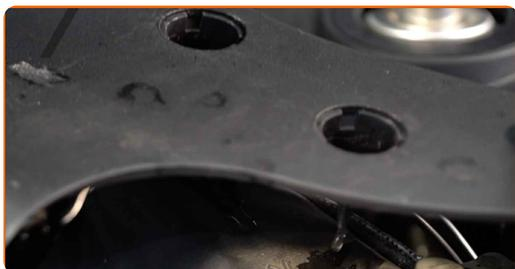
**6** Odstraňte upevňovací prvky krytu vzduchového potrubí. Odpojte kryt vzduchového potrubí od krytu vzduchového filtru.
