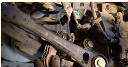
Výměna: tyčky stabilizátoru - VW PASSAT (3B2). Doporučují odborníci z AUTODOC:
