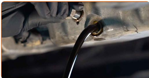
**Výměna: motorového oleje a filtru - VW Passat B1 Hatchback (32). Tip od AUTODOC:**
