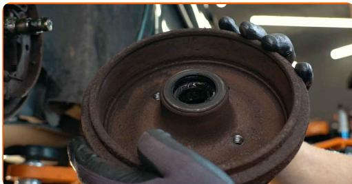
Výměna: brzdové čelisti - VW Passat B2 Hatchback (32B). Profesionálové doporučují:
