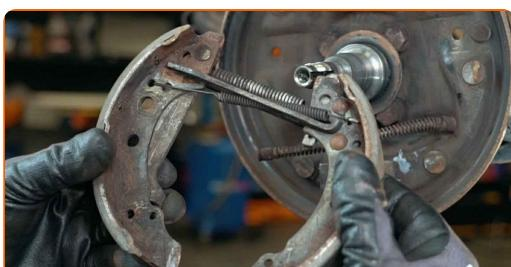
Výměna: brzdové čelisti - VW Passat B2 Hatchback (32B). Tip od odborníků z AUTODOC:
