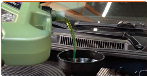
Výměna: motorového oleje a filtru - VW Passat B3/B4 Sedan (3A2, 35i). Tip:
