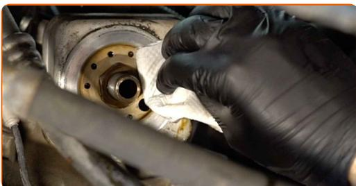
**16** Namažte gumové těsnění nového filtru malým množstvím čerstvého oleje.
