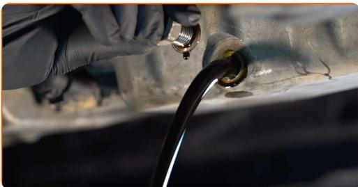
**Výměna: motorového oleje a filtru - VW Passat B3/B4 Sedan (3A2, 35i). Tip od AUTODOC:**
