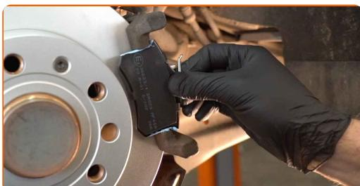
Výměna: brzdové destičky - VW Passat B5 Combi (3B5). Doporučují odborníci z AUTODOC:
