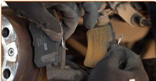
Výměna: brzdové destičky - VW Passat B5 Combi (3B5). AUTODOC doporučuje:
