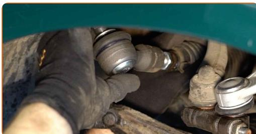
Výměna: kulového čepu řízení - VW Passat B5 Sedan (3B2). AUTODOC doporučuje:
