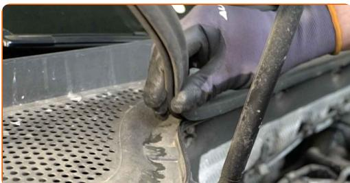
**4** Odstraňte držáky plastové mřížky pro odvádění vody. Použijte páčidlo.
