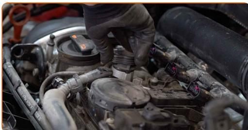
Výměna: zapalovacích svíček - VW Passat CC (357). Tip od odborníků z AUTODOC:
