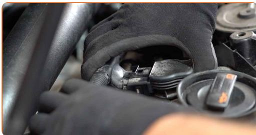
Výměna: zapalovacích svíček - VW Passat CC (357). Doporučují odborníci z AUTODOC:
