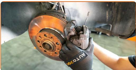
Výměna: brzdového třmenu - VW PASSAT karoserie/kombi (365).
