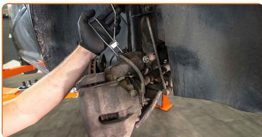
**11.2** Odšroubujte prvky brzdové hadičky od brzdového třmenu. Použijte nástavec č.11. Použijte ráčnový klíč. Brzdovou hadici dejte stranou. Přivažte brzdovou hadici ke karoserii pomocí háčku nebo drátu.
