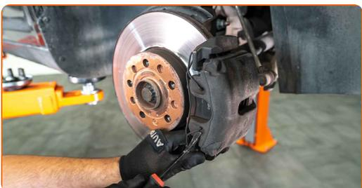
**15** Odšroubujte upevnění brzdového třmenu. Použijte imbusový klíč č. H7.
