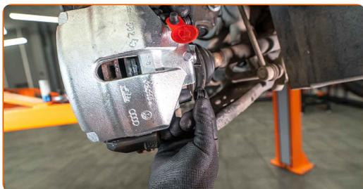
**26** Nainstalujte pružinu brzdového třmenu.
