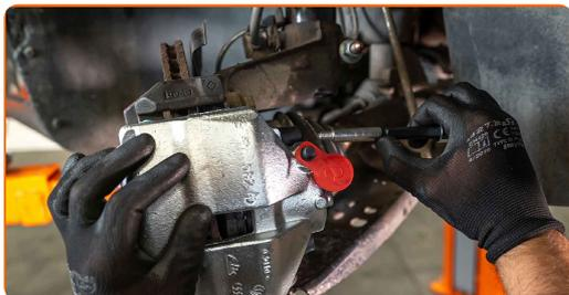
**Výměna: brzdového třmenu - VW PASSAT karoserie/kombi (365). Tip od AUTODOC:**
