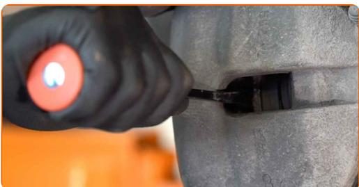
**14** Použitím jednoduchého šroubováku odstraňte svorku pružiny brzdového třmenu.
