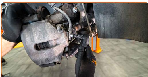
**12** Odstraňte krytky prachového pouzdra vodících závlaček brzdového třmenu.
