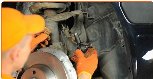
Výměna: kulového čepu řízení - VW PASSAT limuzína (32B). Tip od odborníků z AUTODOC:
