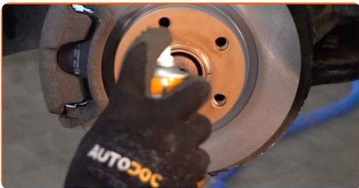
**19** Vyčistěte povrch brzdového kotouče. Použijte čistič brzd.
