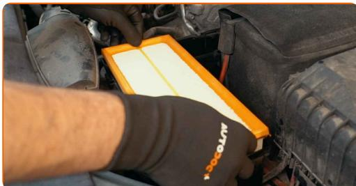
Výměna: vzduchového filtru - VW Passat NMS (A32, A33). AUTODOC doporučuje:
