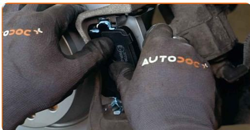
Výměna: brzdové destičky - VW Passat NMS (A32, A33). Tip od odborníků z AUTODOC:
