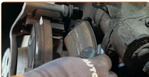
Výměna: brzdové destičky - VW Passat NMS (A32, A33). Doporučují odborníci z AUTODOC:
