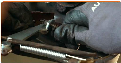
**25** Nainstalujte brzdové čelisti na pracovní brzdový válec, na svorku podpůrného kotouče brzdy.
