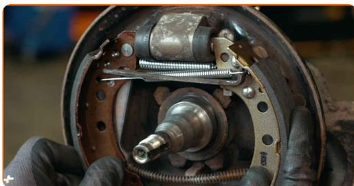
**26** Nainstalujte držáky čelistí bubnové brzdy. Použijte nástroj na montáž pružiny brzdové čelisti.
