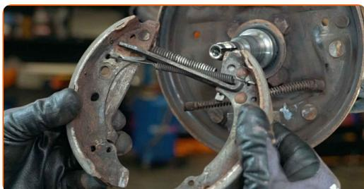
**Výměna: brzdové čelisti - VW Passat Variant (33B). Tip od odborníků z AUTODOC:**
